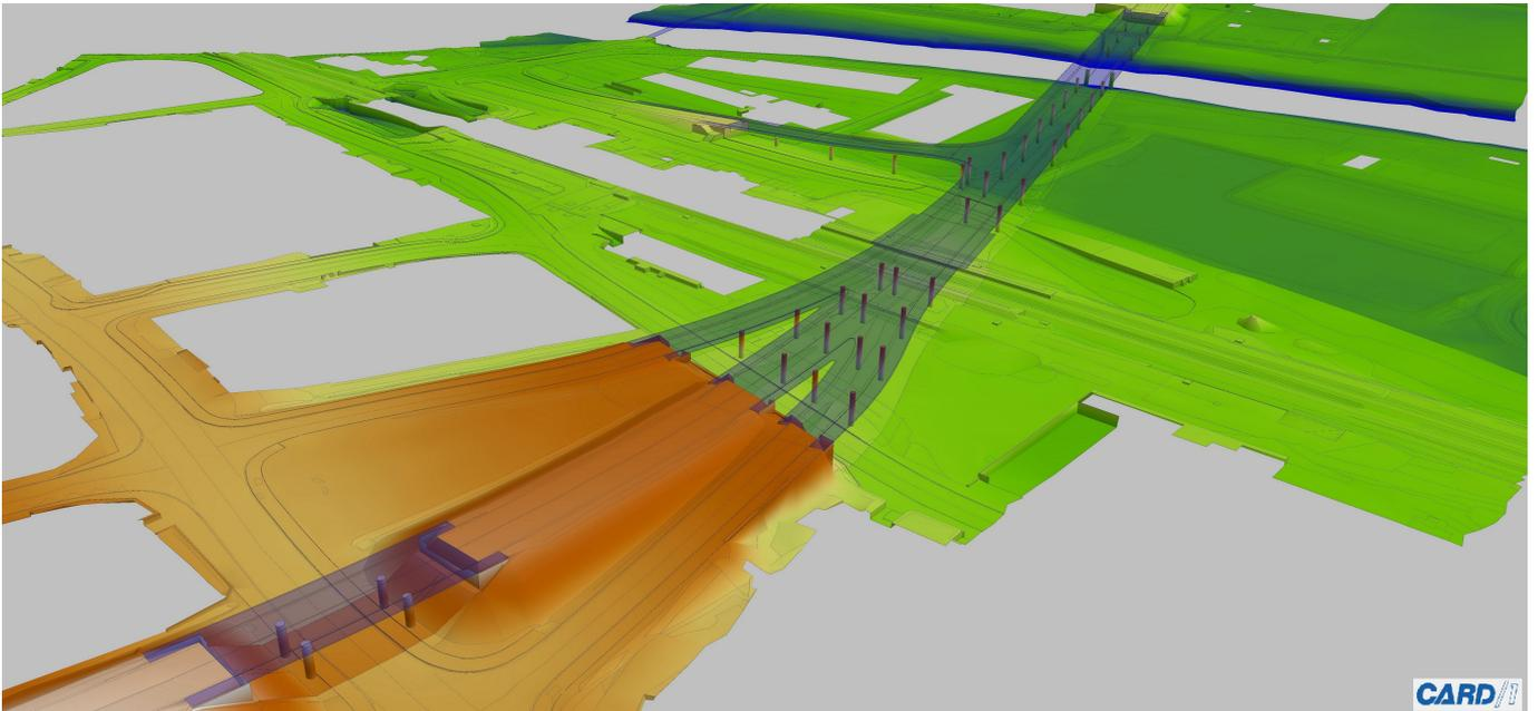
Für den Ersatzneubau der Brücke BW über die Eder und UF DB in Felsberg-Gensungen wurden durch EIBS verschiedene DGM Modelle örtlich erfasst und im CAD System VESTRA und CARD/1 erstellt.
