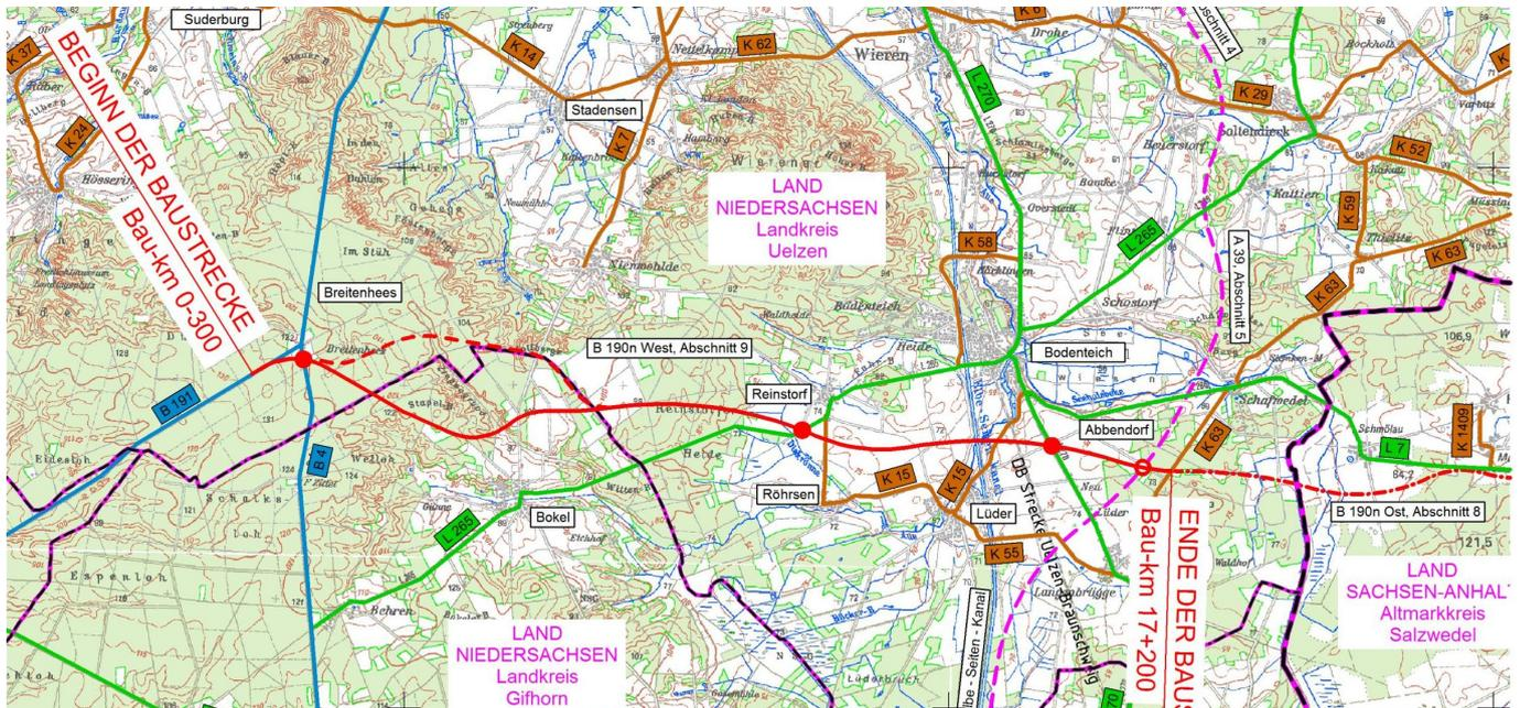
Das geplante Vorhaben ist Teil des Gesamtprojektes Neubau der A 39 mit großräumiger Verkehrsbedeutung. Die B 190n dient als Verbindung in Richtung Westen in Verlängerung mit der B 191 bis nach Celle. Im Zusammenhang mit dem östlichen Teil der B 190n wird eine Querspange nach Sachsen-Anhalt bis nach Salzwedel und weiter zur geplanten A 14 geschaffen.
